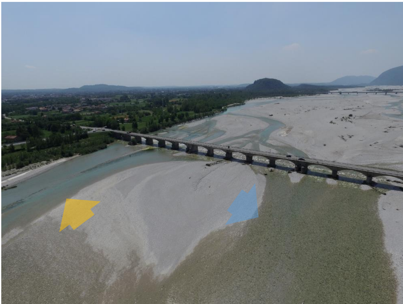
Figura 51: suddivisione in canale principale (freccia arancio) e canale secondario (freccia azzurra) per la stazione "Braulins".
